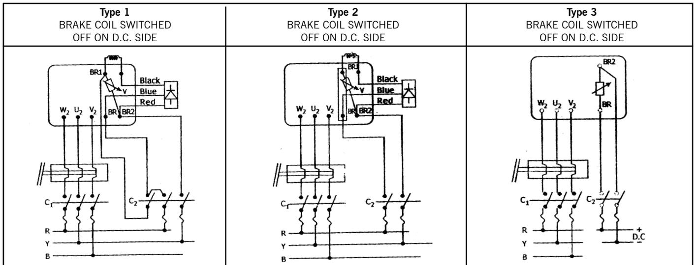
THE MOTOR MUST NEVER BE SWITCHED ON UNLESS THE BRAKE IS ENERGISED AND THE BRAKE SHOULD NEVER BE DE-ENERGISED WHEN THE MOTOR IS ON THE INTERLOCKING OF TWO CONTACTORS IS ABSOLUTELY NECESSARY.
